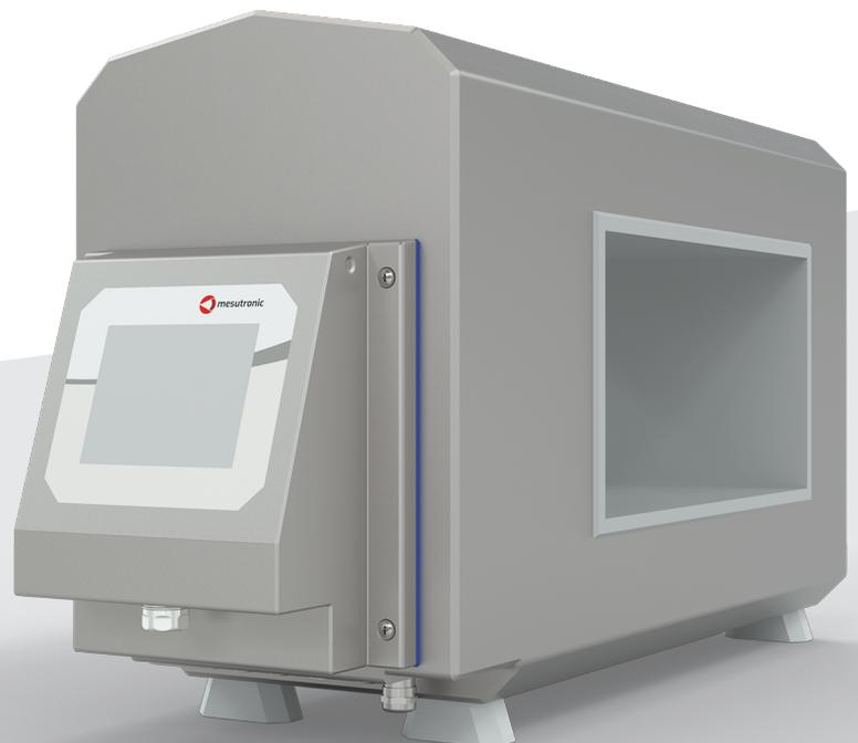
Les systèmes de détection de métaux **METRON 07FL** sont montés directement sur l'épaule de formage de la machine d'ensachage. Grâce à leur blindage solide, les appareils peuvent fournir une grande précision avec un espace de montage minimal, qu'il s'agisse d'inspecter des pommes de terre bouillies ou des fruits secs
