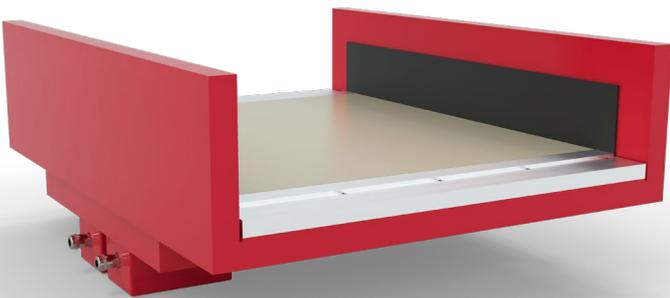
Für Vibrorinnen mit bereits bestehender metallfreier Zone bietet sich die Installation eines Plattenmetalldetektors des Typs **METRON 05 S** an. Diese Anlage ist sehr einfach zu installieren und erkennt zuverlässig Metallteile bis zu einem Abstand von etwa 250 mm von der Tasteroberfläche. Eine Sonderform stellt die **METRON 05 U** dar. Hier ermöglichen die aufgestellten Seiten, auch bei Schütthöhen bis 400 mm noch passable Erkennungsgenauigkeiten zu erreichen.
